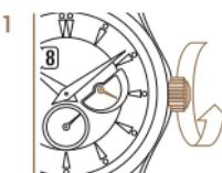
Вращать заводную головку по часовой стрелке до тех пор, пока стрелка индикации запаса хода не дойдет хотя бы до середины шкалы.
