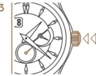
*Poussez la couronne pour la replacer en position initiale. L'aiguille des secondes se remet en marche.*
