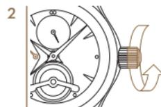
*Ruotare la corona in senso orario, fino a che la lancetta dell'indicatore dell'autonomia non ha raggiunto la parte più alta della scala.*
