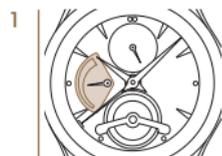
*El área de escala completa le muestra una reserva de energía de 70 horas.*
